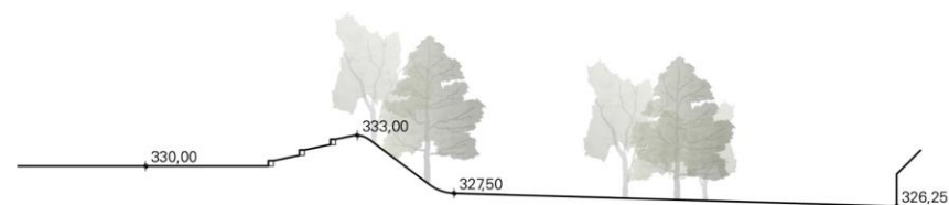
Schemaschnitt Lärmschutzwand mit integrierter Tribüne
